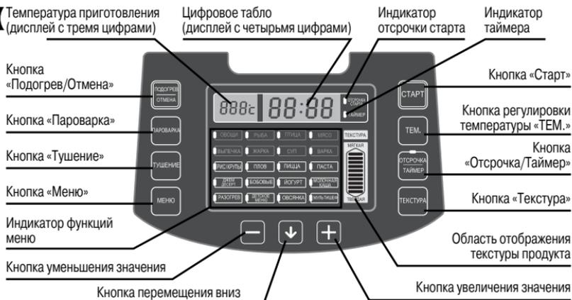
1. Управление мультиваркой осуществляется с помощью 11 кнопок: «Подогрев/Отмена», «Пароварка», «Тушение», «Меню», «Старт», «Регулировка температуры», «Отсрочка/таймер», «Текстура», «+», «-», «↵». Нажатие кнопок сопровождается звуковым сигналом. В режиме ожидания управление осуществляется только следующими кнопками: «Подогрев/Отмена», «Пароварка», «Тушение» и «Меню».
